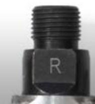
Pedale destro - avvitate in senso orario.
