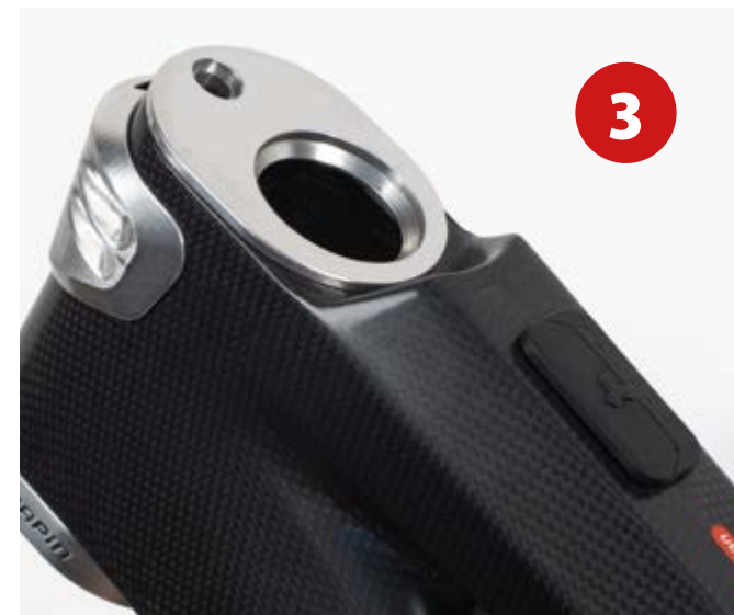
3. Serie sterzo ISA in configurazione arretrata di 8 mm.
