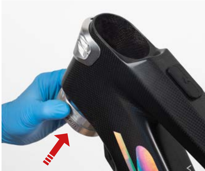
1. Inserite l'adattatore inferiore della serie sterzo ISA.
