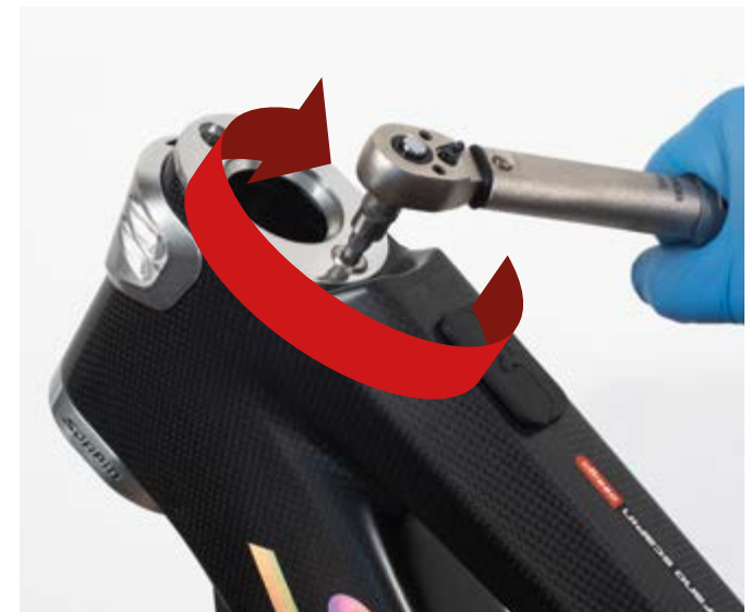
6. Serrate le viti con la chiave dinamometrica alla coppia di serraggio di 4 Nm.
