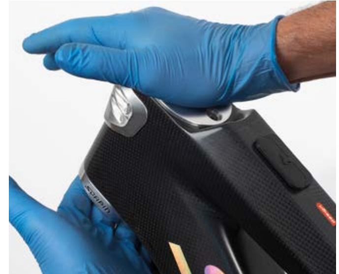
3. Premete con entrambe le mani per mandare a battuta i due adattatori.
