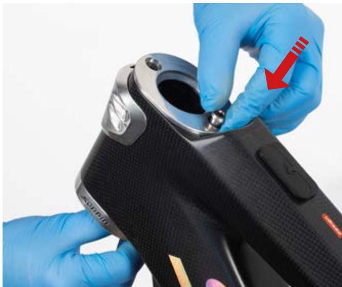
4. Inserite le viti di fissaggio degli adattatori AWS.
