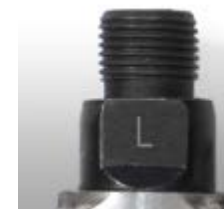
Pedale sinistro - avvitate in senso antiorario.
